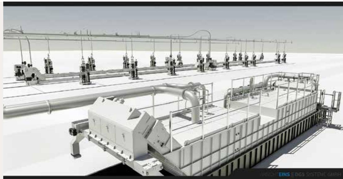
Zentrale Kühlmittelversorgungsanlage zur Stahlkolbenproduktion für 2 Fertigungslinien
